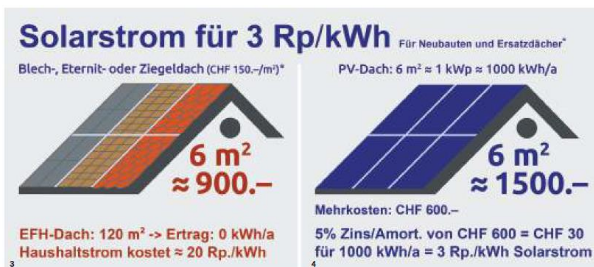
Abb. 3 und 4: Solarstrom für 3 Rp./kWh und Rechtsgleichbehandlung: In fünf Kantonen wurden 2018 Offerten für 1 m² Blech-, Eternit- und Ziegeldach für etwa 100 m² ausgewertet. Im Durchschnitt kostet ein traditionelles Dach rund 150 Fr. m². 6 m² kosten somit (6×150 Fr.) ≈ 900 Fr. Eine PV-Anlage von 6 m² kostet (ab 5 kW) ca. 250 Fr./ m² inkl. Wechselrichter etc. Ergibt somit ≈ 1'500 Fr. bzw. 600 Fr. teurer als 6 m² Blech-/Eternit-/Ziegeldach. 6 m² PV ≈ 1 kW generiert ≈ 1'000 kWh/a für 600 Fr. Mehrkosten. Zu 5% Zins inkl. Amortisation von 600 Fr. resultieren ≈ 30 Fr. für 1'000 kWh/a, d.h. Solarstrom ≈ 3 Rp./kWh für Neubauten und Ersatzdächer (Inzwischen Offerten unter 1'000 Fr./kW). «Ungerechtfertigte technische Handelshemmnisse» sind ge-
